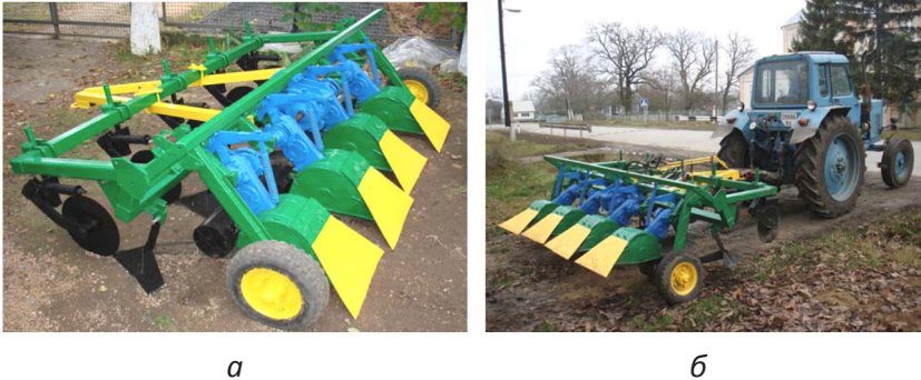
Рис. 2. Дослідний зразок подрібнювача рослинних залишків грубостеблових культур КФП-2,8: а – загальний вигляд; б – в транспортному положенні
