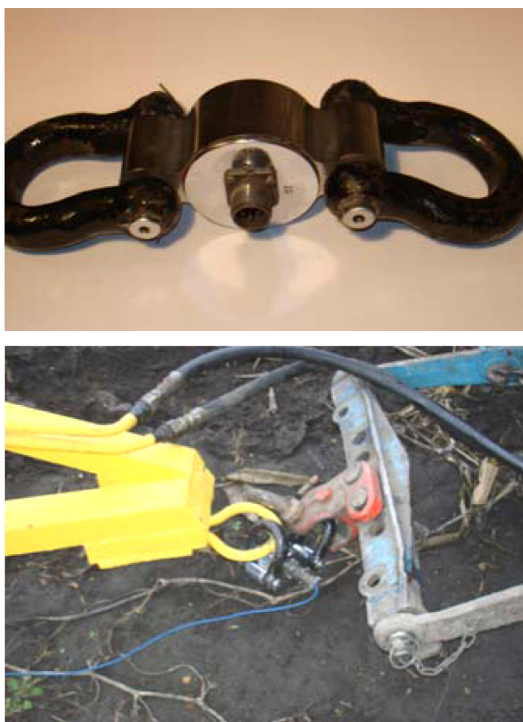
Рис. 6. Обладнання для вимірювання тягового опору експериментальної польової установки подрібнювача
