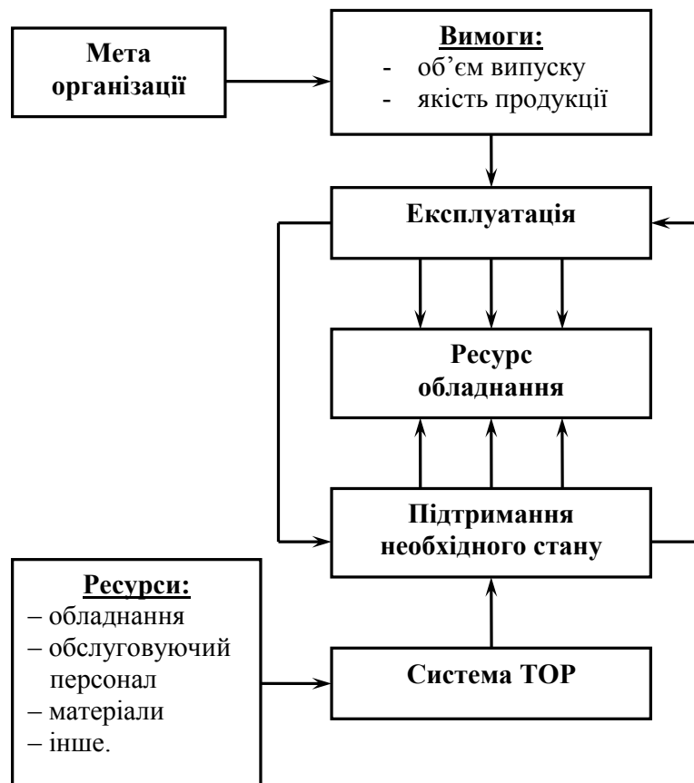
Рис. 1. Місце системи ТОР у виробничому процесі енергопідприємства
