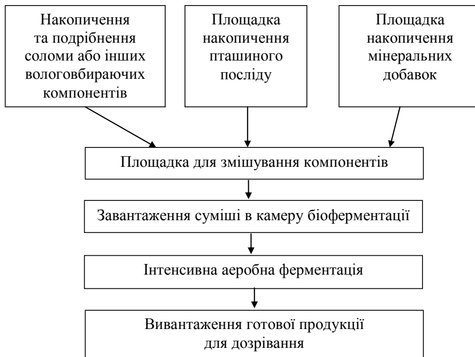
Рис. 1. Технологічна схема виробництва органічних добрив нового покоління.
